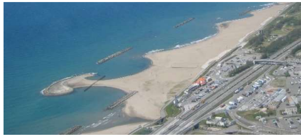
侵食対策として整備した、石川海岸 (松任工区) の砂浜を海岸保全施設として指定 (海岸法に基づく指定としては初の事例)
