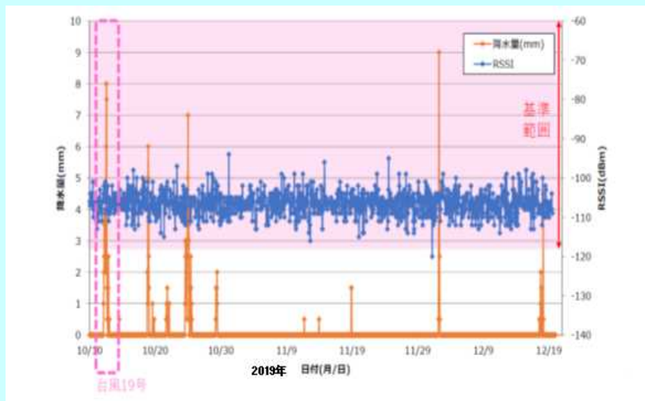
図-6 LoRaWANの電波強度と降水量の相関
