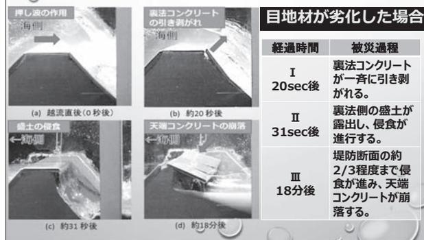
こちらは三面張りコンクリートを模擬した堤防模型でして、模型の縮尺は1対15、実物換算で6.0mの堤防です。表側のコンクリートは厚さ50cm、天端裏側は25cm程度のコンクリートを張りつけております。実験では、この目地の部分に着目しまして、目地が地震によって遮水性が失われた場合と、目地が健全な場合について、それぞれ実験を行いました。まず初めに、目地の遮水性が失われた場合の実験結果ですが、越流を開始しますと、目地材の間に越流水が入りまして、堤体の内部から被覆工を押し出すという現象で被覆工が流出し、露出した盛土材が内陸側に溜まった海水の波によって堤体がだんだん侵食されていきます。最終的には、堤体断面が減少して、天端コンクリートが崩落する。このような現象が実験でも検証されております。
